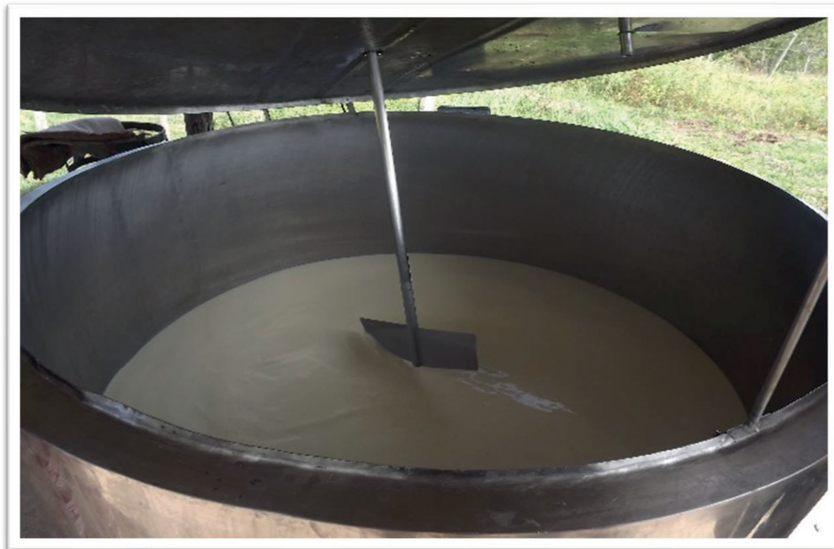
Figura 7 – Tanque de resfriamento de leite em propriedade no município de Vila Nova dos Martírios
